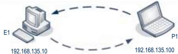
Fig. 5.10. Prueba desde la red inalámbrica a la cableada.
